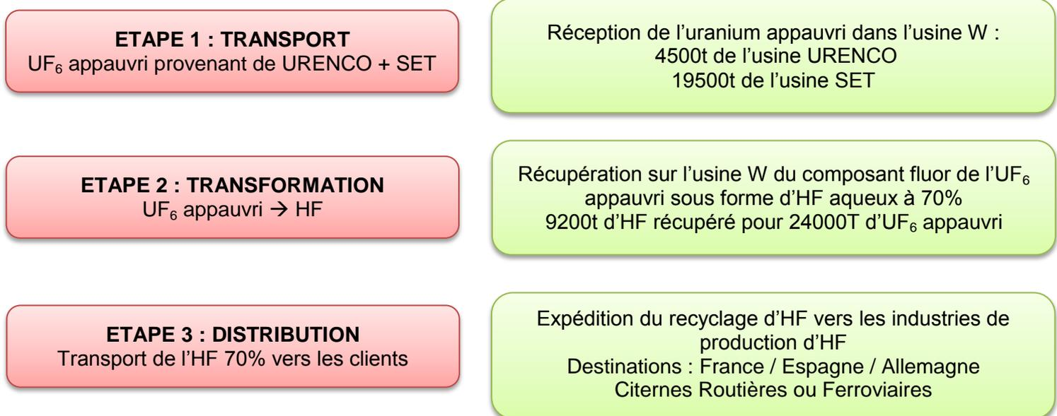
L'uranium appauvri provient essentiellement de l'usine SET. Une autre partie de l'UF<sub>6</sub> appauvri arrive des usines URENCO dont les activités sont liées à l'enrichissement de l'uranium avec le procédé de centrifugation comme SET.
