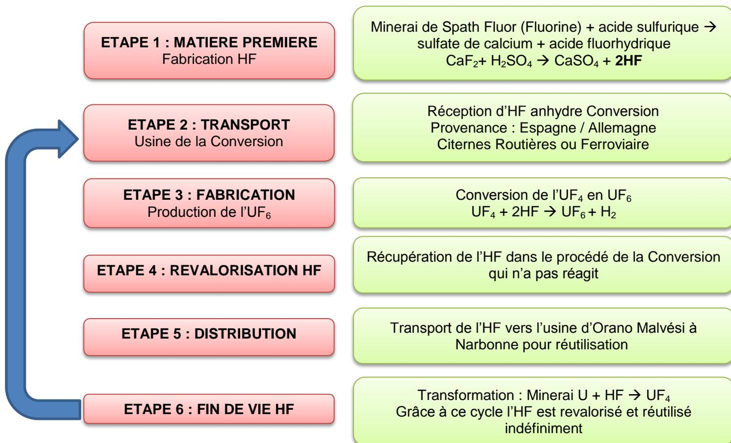
L'HF utilisé pour l'usine de la Conversion de l'uranium est un HF anhydre à 100%. Le site du Tricastin et les équipes logistiques achètent cet HF à deux fournisseurs :
