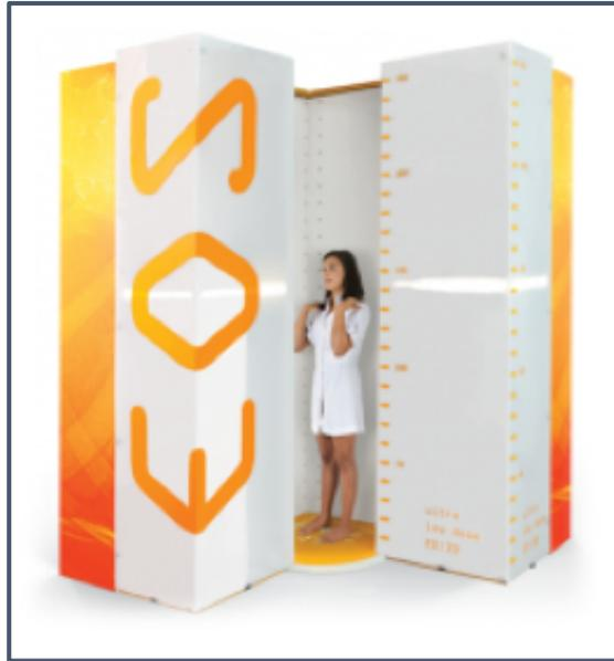
*Figure 4: Cabine EOS permettant la réalisation de radiographies biplanaires et une vue tridimensionnelle du rachis en position de fonction*
