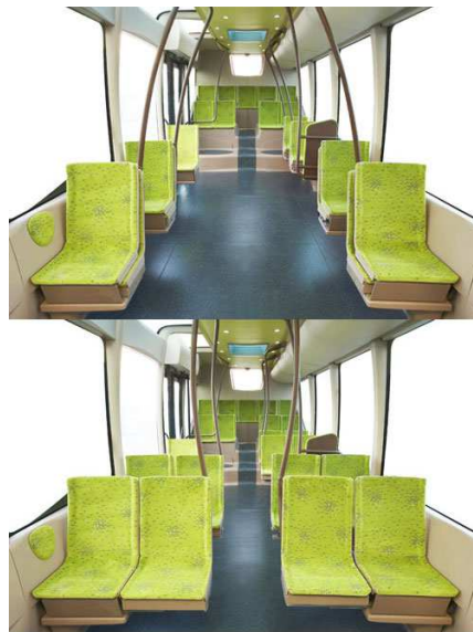
Figure 14 - Modularité du bus proposé par Irisbus Iveco dans le cadre du projet EBSF 36
