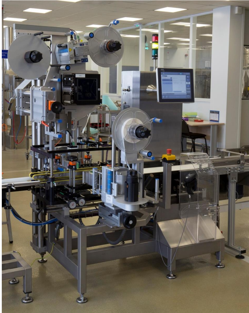
Figure 12. Equipement de s rialisation et d pose vignettes install es
