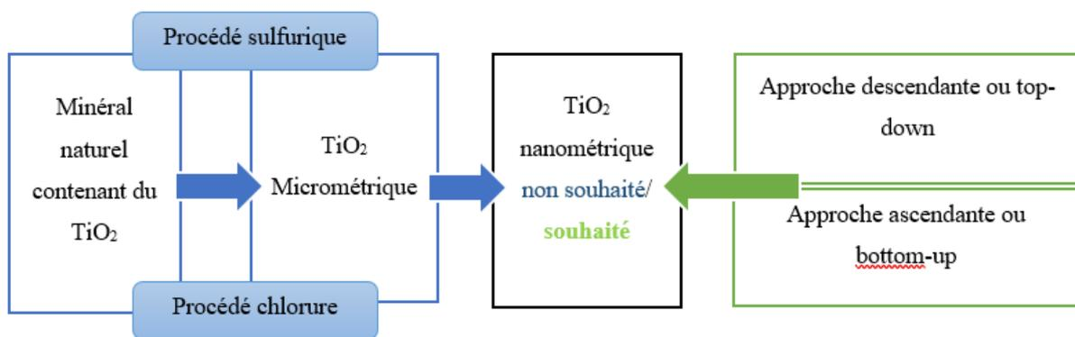
**Figure 16 : Obtention des nanoparticules de TiO<sub>2</sub>**
