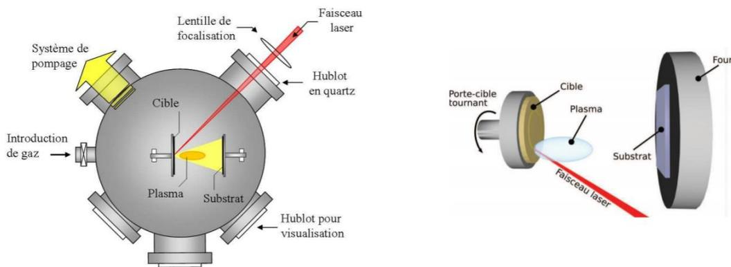
**Figure 22 : Principe d'ablation laser pulsé (62)**
