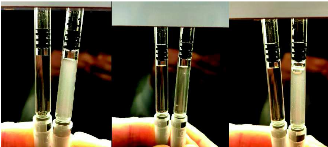
Figure 35 : Détection de 3 seringues troubles à la lecture TRA 11
