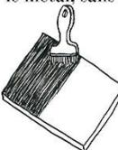
On applique du vernis avec un pinceau, pour protéger la plaque de cuivre de l'attaque de l'acide. On soulève ensuite le vernis, en l'éraflant avec la pointe sèche.
