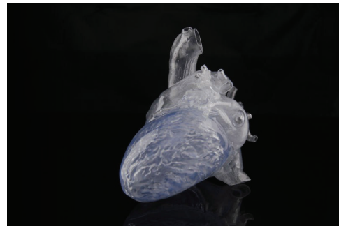
Figure 25 : Rapid Prototyping d'un cœur imprimé, Materialise.
