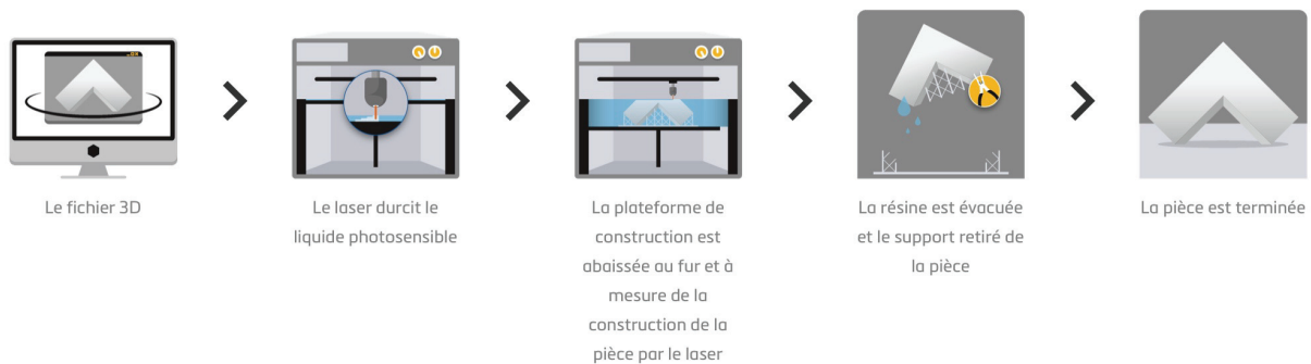
Figure 49 : Étapes de fabrication d'un guide de coupe par StéréoLitographie, Materialise
