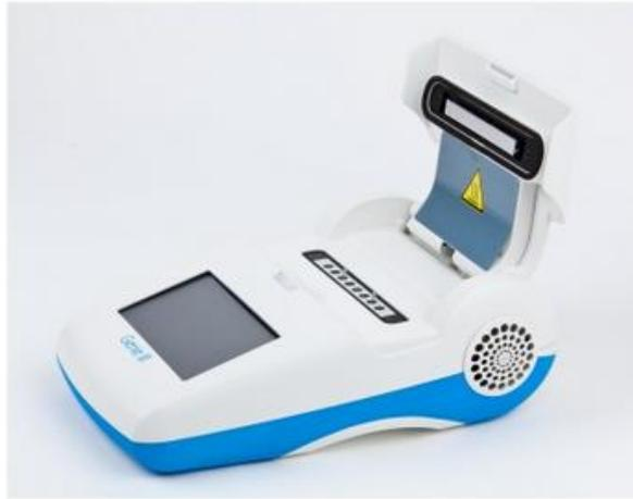
Figure 18 : dispositif Genie III, permettant de d'amplifier en temps réel les acides nucléiques (ADN ou ARN) de l'échantillon testé par la méthode LAMP. Cet instrument portable permet de visualiser les résultats directement sur l'écran tactile. Il dispose d'une batterie qui lui permet d'être utilisé en ambulatoire et de connexion wifi et Bluetooth pour faciliter le transfert de données (34).
