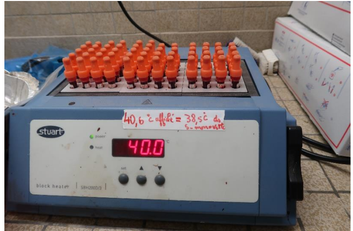
Bain à sec contenant des monovettes en cours d'incubation
