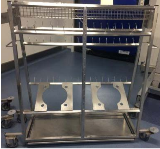
Figure 46: Chariot de lavage conditionnement tube vide
