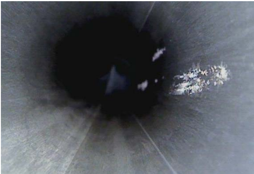
Figure 60: Photo de l'intérieur d'un tuyau avec des résidus de poudre
