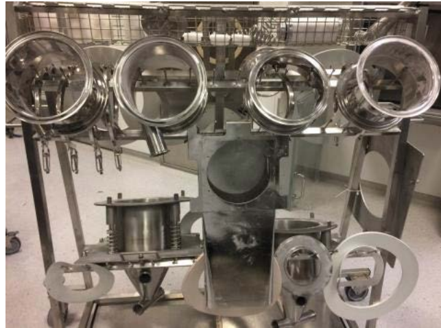
Figure 45: Chariot de lavage conditionnement tube avec les pièces à nettoyer
