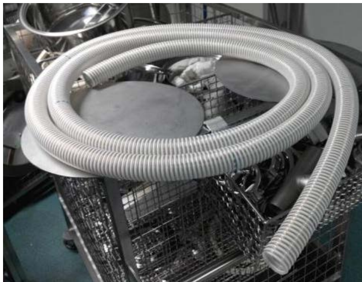
Figure 38: Photo tuyau trop long pour un lavage automatique
