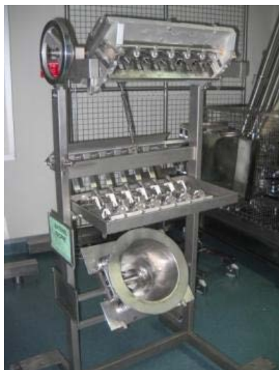
Figure 53: Photo chariot groupe de dosage nettoyé manuellement
