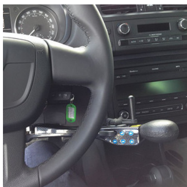
photo 5 : véhicule adapté avec commande manuelle au volant (en cas de paraplégie)
