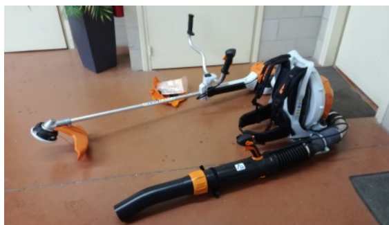
Photo 4 : débroussailleuse et souffleuse combinées pour un agent ayant un handicap d'un membre supérieur
