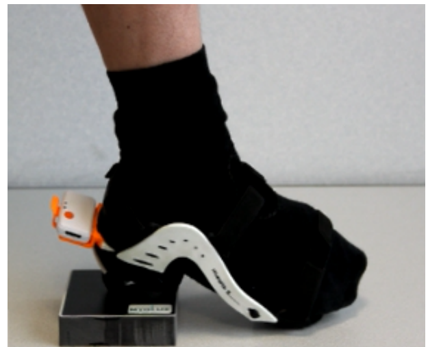
Annexe 3 : Mesure de la vitesse angulaire en charge : le sujet, debout, en appui monopodal, genou tendu, le talon du dispositif en charge sur une cale de 2,5 cm de haut, avait pour consigne de réaliser une inversion de cheville de la manière la plus lente et fluide possible.
