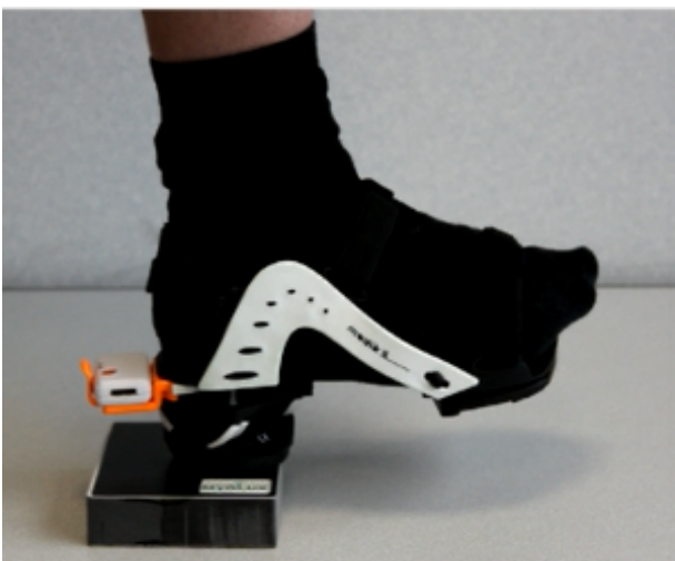
Annexe 3 : Mesure de la vitesse angulaire en charge : le sujet, debout, en appui monopodal, genou tendu, le talon du dispositif en charge sur une cale de 2,5 cm de haut, avait pour consigne de réaliser une inversion de cheville de la manière la plus lente et fluide possible.
