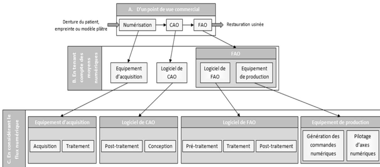
Figure 7 : Structure de la chaîne numérique en CFAO (d'après <sup>16</sup>)
