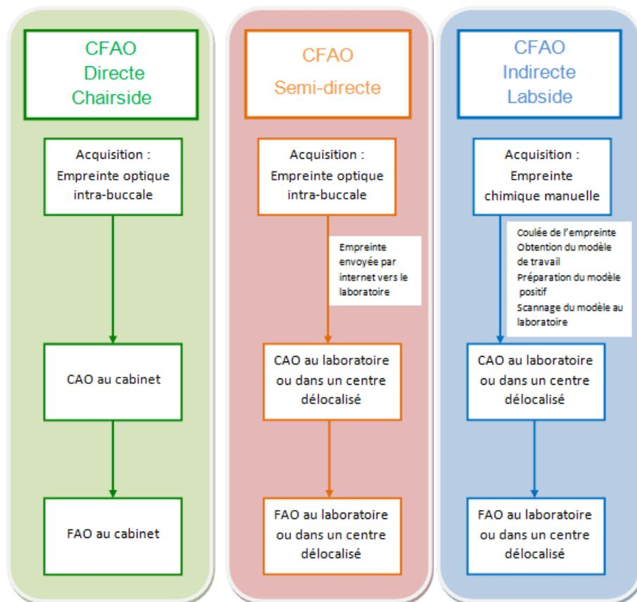
Figure 10 : les différents modes de CFAO<sup>18</sup>
