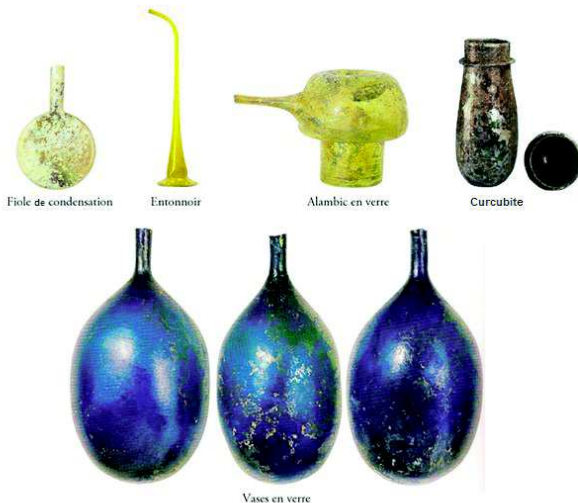
Figure 33 : Quelques instruments de laboratoire de chimie utilisé par Jabir Ibn Hayyan. The Nasser D.Khalili Collection of Islamic Art - [GLS 199,252-1-3,324, 374]. London La cucurbite en verre, ainsi appelée car en forme d'une courge. Elle servait à la sublimation au terme de laquelle un corps solide transformé en vapeur était épuré. 307
