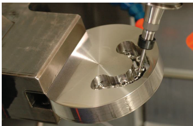
Figure 39 : Usinage d'armature en CFAO
