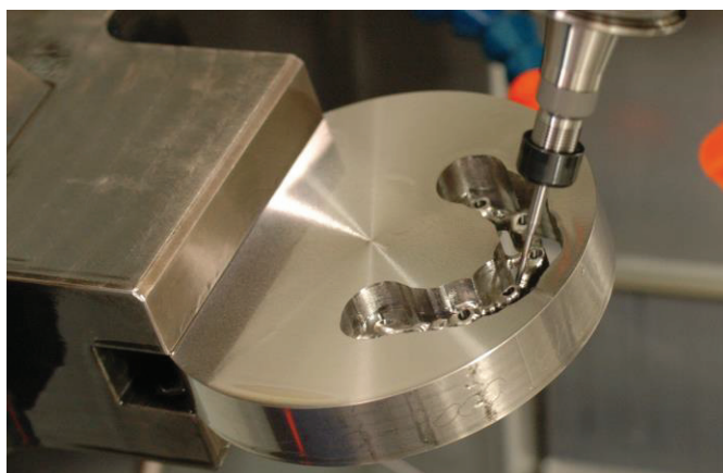
Figure 39 : Usinage d'armature en CFAO
