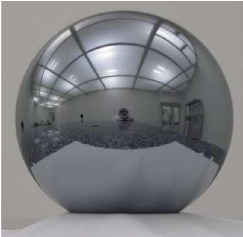
**Figure 23 : La sphère de silicium 1 kg Si01LNE.**
