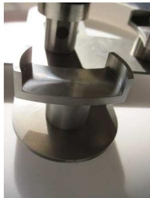
**Figure 19 : Support de masse OIML.**
