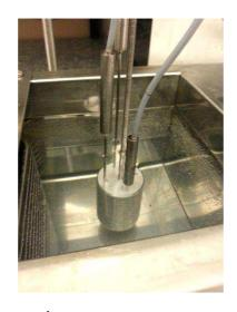
Figure 34 : Étalonnage des sondes de température.
