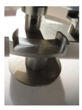
Figure 19: Support de masse OIML.
