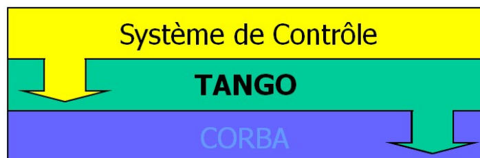
Figure 8 : Imbrication de TANGO dans le système de contrôle (tiré de la banque d'images du synchrotron-soleil)
