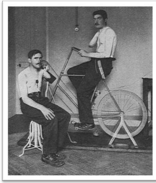
**Figure 44 : appareil permettant d'obtenir la puissance fonctionnelle du moignon (cycle ergométrique du professeur Amar) (1917, Larousse médical illustré de guerre.)**
