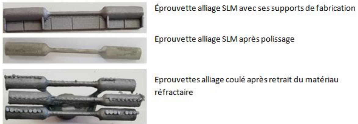
Figure 34 : Photographie d'éprouvettes fabriquée en fusion laser ou par coulée (Photographies BERGES B)
