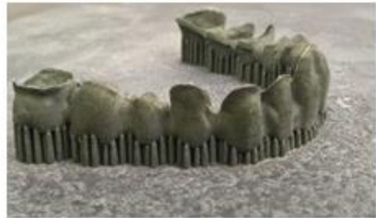
Figure 13 : Productions en fin de fabrication, avant retrait des supports et post-traitement. Laboratoire OMNIUM dentaire Bordeaux, MAREMBERT B, BERGES B.
