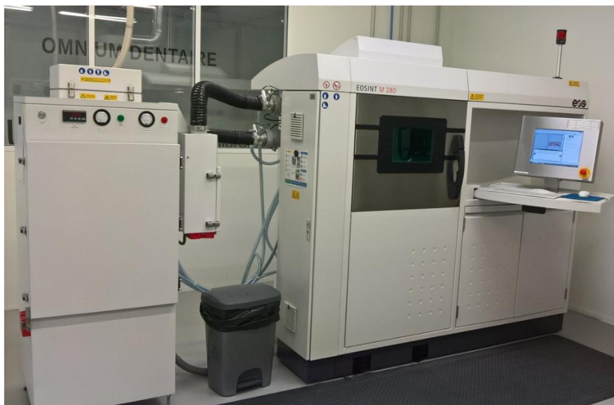
Figure 14 : Machine de production EOSINT M280, Centre de production OD3D Bordeaux.
