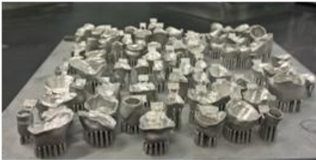
Figure 13 : Productions en fin de fabrication, avant retrait des supports et post-traitement. Laboratoire OMNIUM dentaire Bordeaux, MAREMBERT B, BERGES B.
