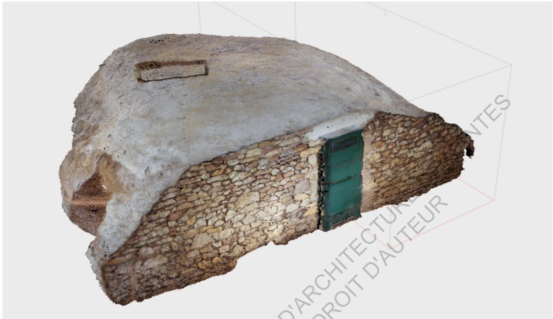
(fig 8) Plaquage de texture – Modèle 8 M de faces – Photogrammétrie L.Lescop
