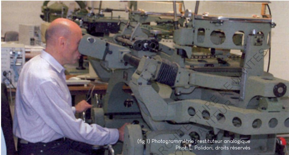
(fig 1) Photogrammétrie ; restituteur analogique
