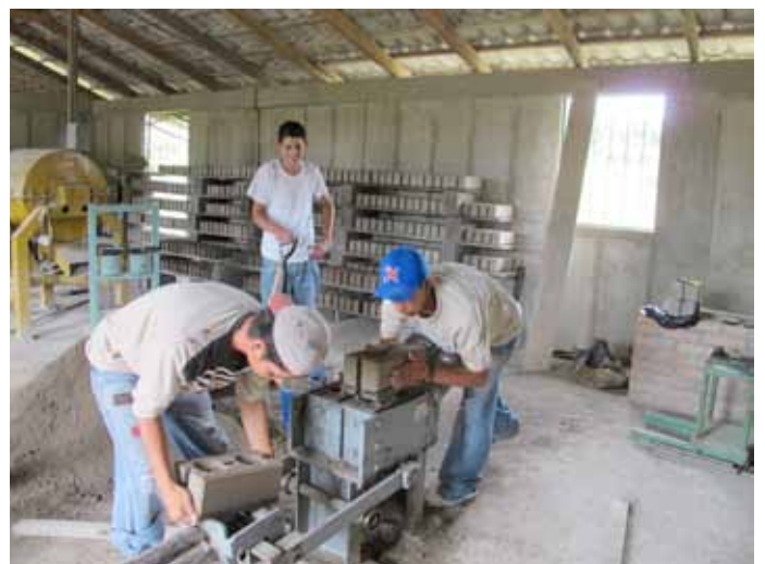
Figure 81- Les briques démoulées doivent être manipulées avec précaution (Source : photographie personnelle)
