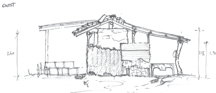
Figure 68- Façade Ouest, vue sur l'ancienne habitation : la partie « cuisine et salle d'eau » - fermée par de la tôle et des planches de bois - et la partie « lavoir », zone ouverte (Source : élaboration propre)
