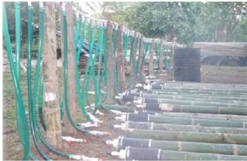
Figure 91- Rosita, traitement des bambous au borax (Source : CO2 Bambu)
