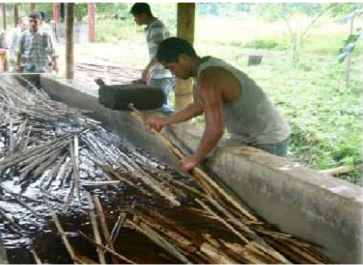
Figure 89- Rosita, traitement des bambous au borax (Source : CO2 Bambu)
