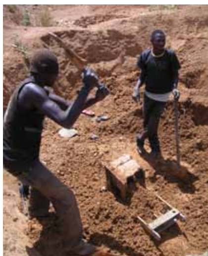
Fabrication de brique cuite : moulage à l'aide de presse type Cinva-ram sur le site de la paroisse St Augustin
