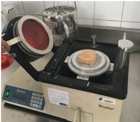
**Figure 13 : Bascule de la chambre de Pression**
