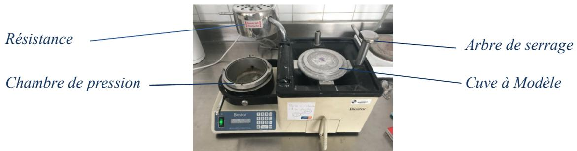
*Figure 10 : Appareil de Thermoformage Biostar® en position initiale*
