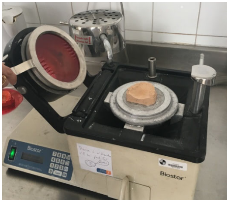
Figure 13 : Bascule de la chambre de Pression
