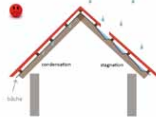
Les poches d'humidité provoquées par la bâche plastique sous-toiture. Les poches d'humidité provoquées par la bâche plastique sous-toiture.
