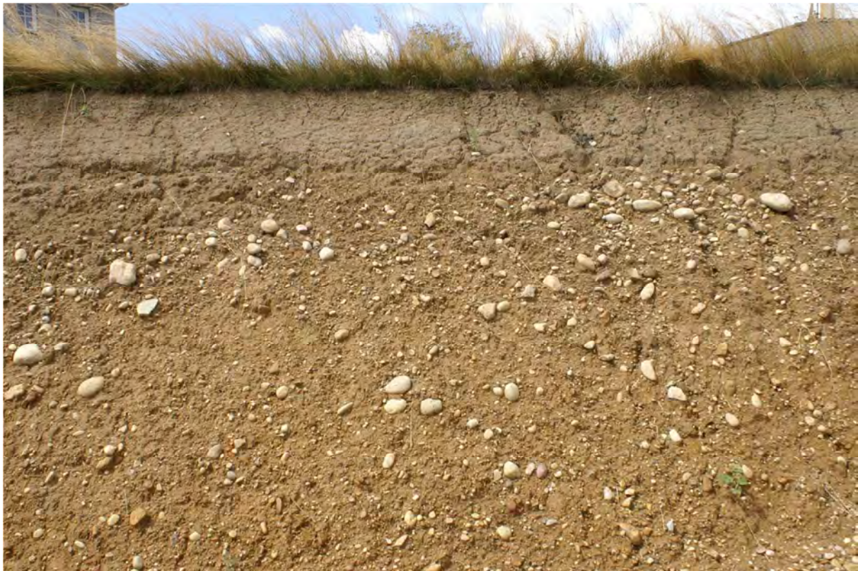
Coupe d'un terrain en Isère, présentant la superposition des différentes couches : végétation et terre organique en partie haute (quelques dizaines de centimètres), moraines glaciaires (mélange d'argile, de silts, de sables, de graviers et de cailloux) en partie basse. Photo. : Patrice Doat, CRATERre.
