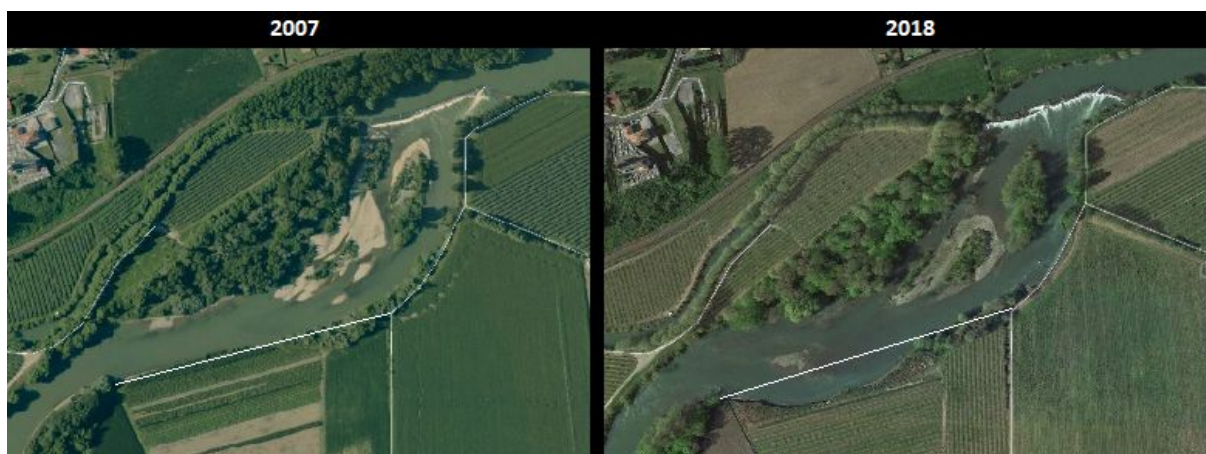
Photographie 1: Érosion de berge en rive gauche sur le Gave de Pau à l'aval du seuil de Cauneilles. Photographies réalisées par Patxiku Lafitte. Montage réalisé par Marion Negre, 2018
