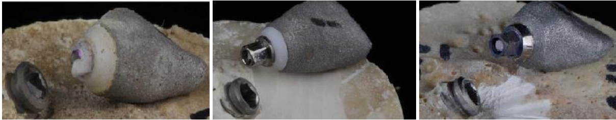
Figure 22: Mode de fracture des 3 types de piliers : Zirconie, TiBase et Titane (gauche à droite).
