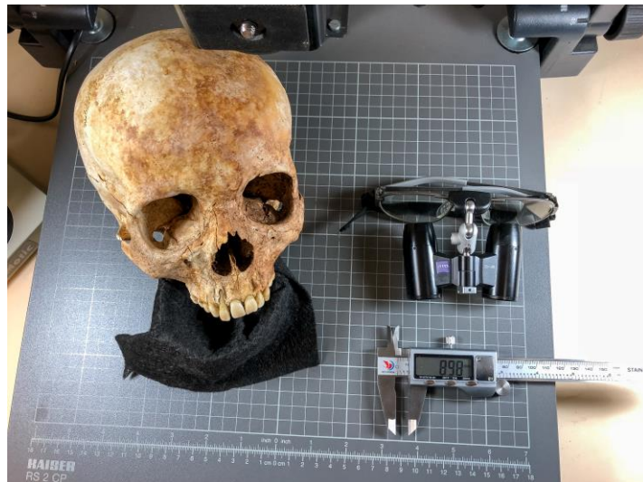
Figure 31 et 32 : Plateau d'examen avec éclairage, étrier numérique, et loupe grossissement 3,5
