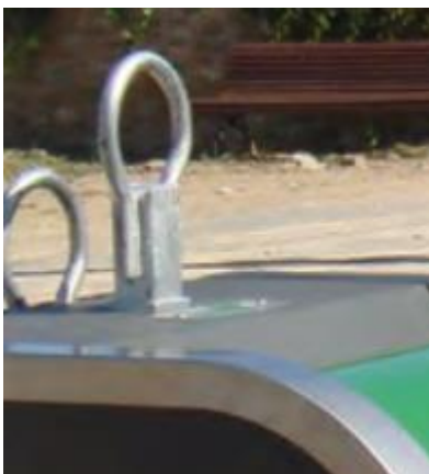
Image 9a : Préhension par simple crochet
