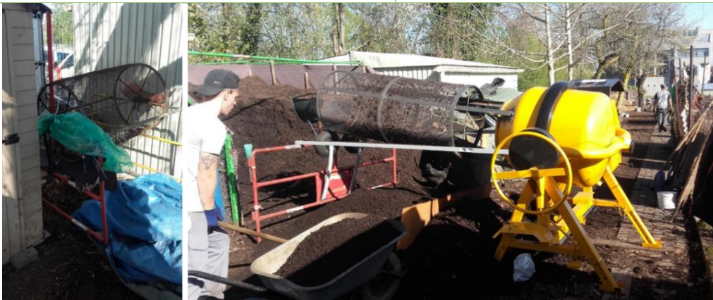
Image 9 Cribles « fait maison » : celle de gauche est actionnée manuellement à l'aide d'une pédale; à droite le moteur de la bétonnière permet de faire tourner le tamis
