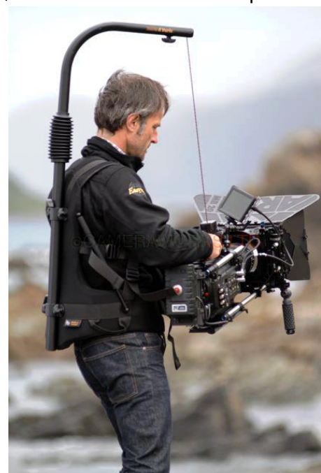
Caméra à hauteur de hanches opérée à l'EasyRig 15
