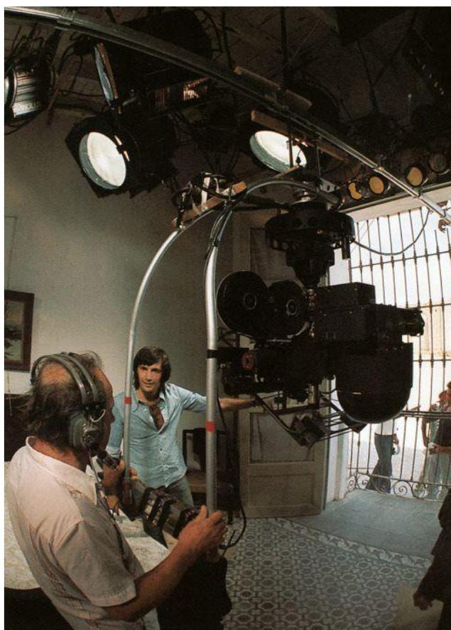
Caméra Mitchell 35mm dans la boule Wescam gyrostabilisé suspendue au rails<sup>1</sup>
