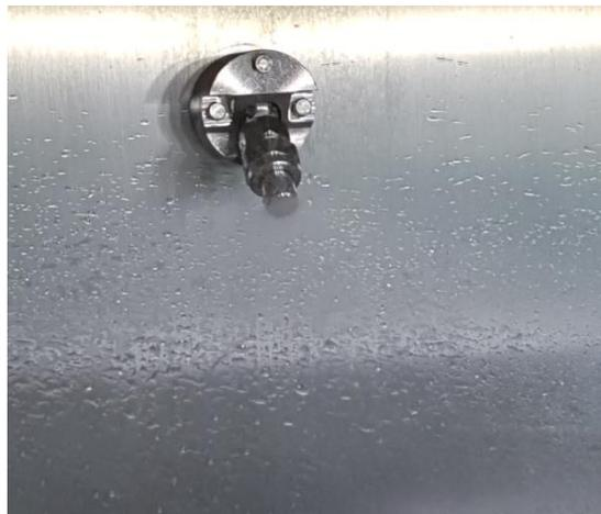
Buse assurant la pulvérisation de la solution d'auto-nettoyage
