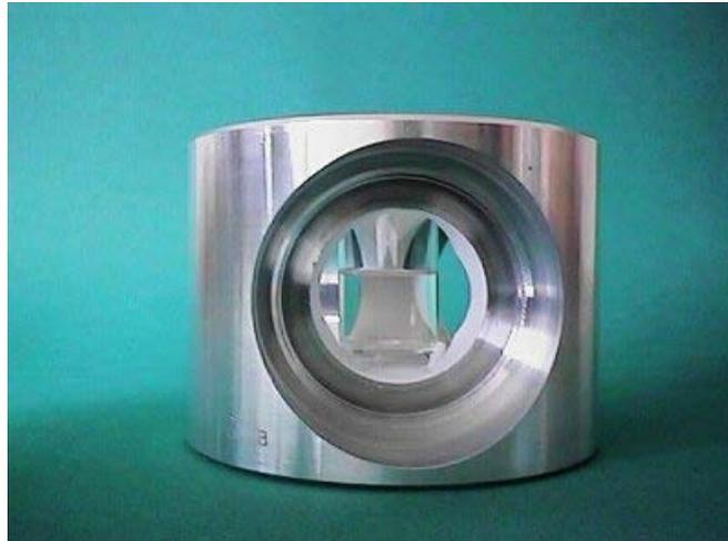
**Figure 10 : Détail de la cellule optique d'un appareil RCTD contenant le flacon de scintillation liquide à mesurer (LNHB)**
