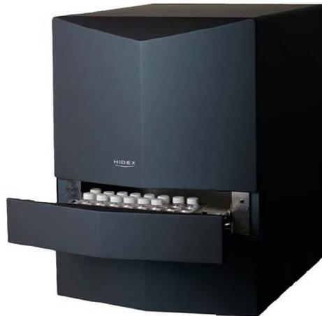
**Figure 12 : Vue générale du compteur à scintillation liquide HIDEX 300 SL™, tiroir du passeur automatique d'échantillons ouvert (HIDEX).**
