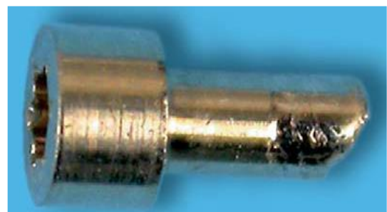
Figure 72 : Vis de piliers fracturée 174
