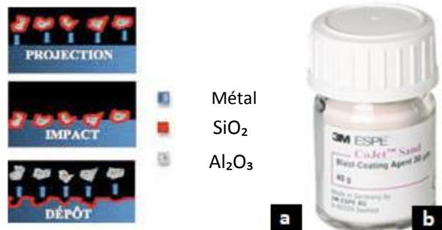
Figure 39 : Le sablage réactif :
