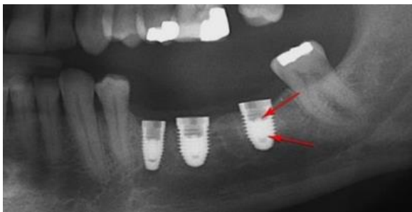
Figure 71 : Radiographie panoramique mettant en évidence la fractures de trois vis de piliers suite à un serrage excessif 175
