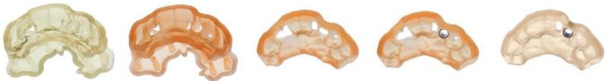
Fig. 61 : évolution du guide implantaire au cours des phases de post-traitement. De gauche à droite : guide imprimé, rincé, supports supprimés, insertion du puit métallique manuellement, après cuisson.
