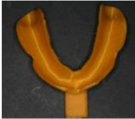
Fig. 49: PEI imprimé en PLA par une machine-outil fonctionnant par FDM
