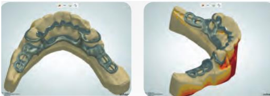
Fig. 22c. tracé virtuel du châssis (logiciel 3Shape)
