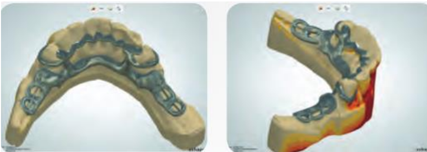
Fig. 22c. tracé virtuel du châssis (logiciel 3Shape)
