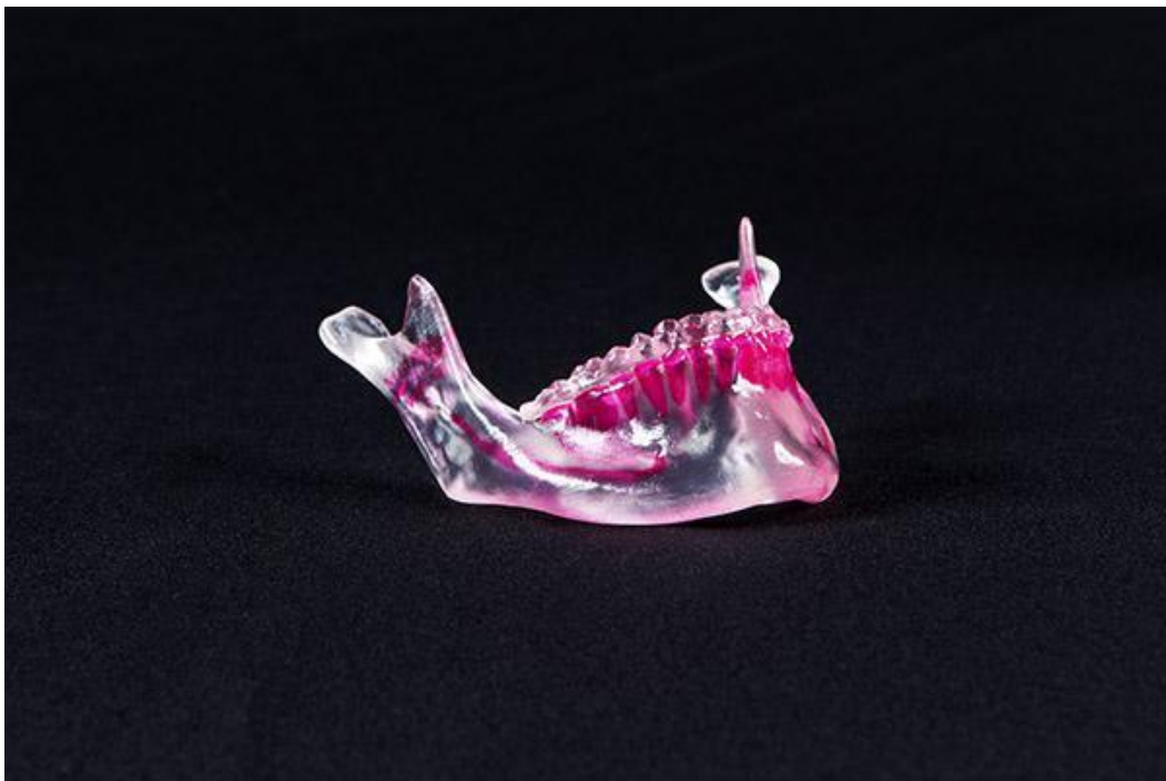
Fig. 40 : maquette d'une arcade mandibulaire imprimée par Polyjet (imprimante Objet Eden 250) à l'hôpital King's College à Londres en préparation d'une opération à risque sur un patient accidenté.
