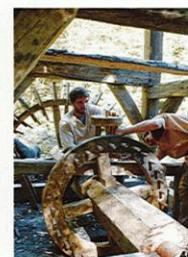
Seules deux pièces du moulin sont en fer, l'anille (24) (36) qui s'encastre dans la meule et le gros fer (38) (39) qui entraîne le tout. Batre le gros fer a demandé un travail à trois forgerons (37). On a assemblé le rouet, la lanterne ainsi que la roue et ses pales (40).
