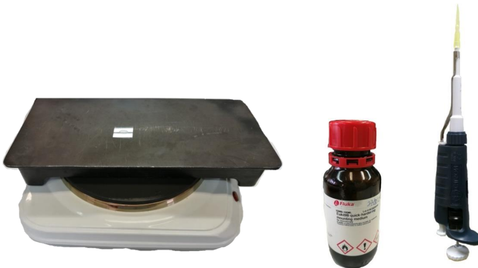
Figure 7: Plaque chauffante, Eukitt et prélève-goutte (source : E. Lacaze)
