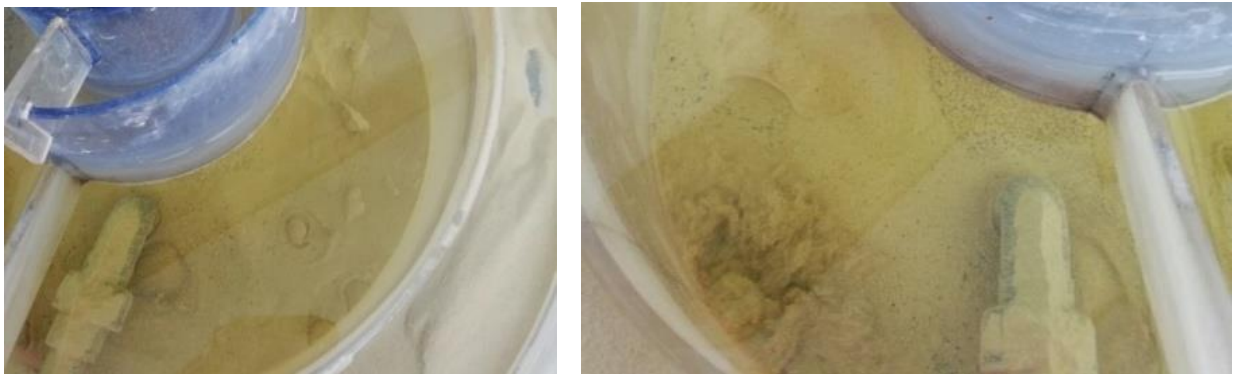
Figure 28. Essai pilote sur le Filtraphos® utilisé avec les cendres 1 en bi-couche avec du sable en fond de cuve. Photos de la surface du lit montrant l'existence de chemins préférentiels, et donc la mauvaise répartition du flux.
