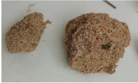
Figure 22. Photos des agglomérats (diamètre de 3 à 10 cm) de PC B retrouvés dans la cuve du mini-Filtraphos® pendant l'essai #0.
