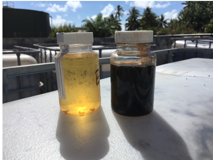
Photo 8: Eaux en sortie des lits plantés de roseaux
