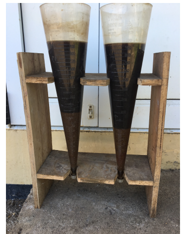
Photo 7: Décantation des boues du Carbofil lors de la phase d'injection de lixiviat et de graisses
