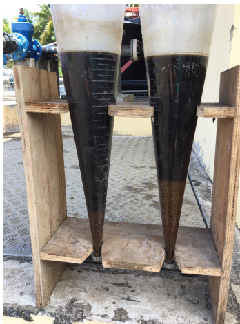
Photo 7: Décantation des boues du Carbofil lors de la phase d'injection de lixiviat et de graisses
