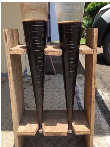
Photo 7: Décantation des boues du Carbofil lors de la phase d'injection de lixiviat et de graisses
