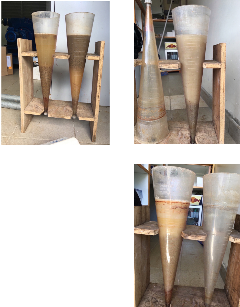
Photo 6: Décantation des boues du Carbofil lors de la phase d'injection de graisses uniquement
