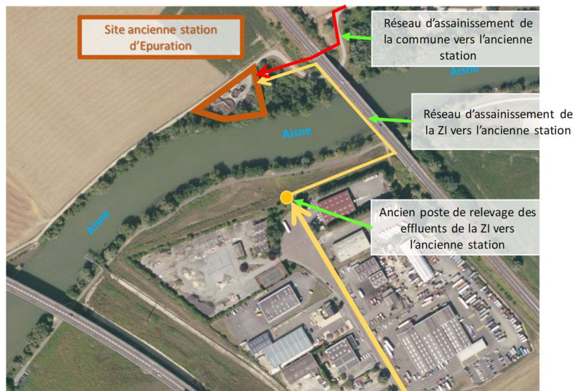
Figure 7: R seau d'assainissement de l'ancienne station de Choisy-Au-Bac
