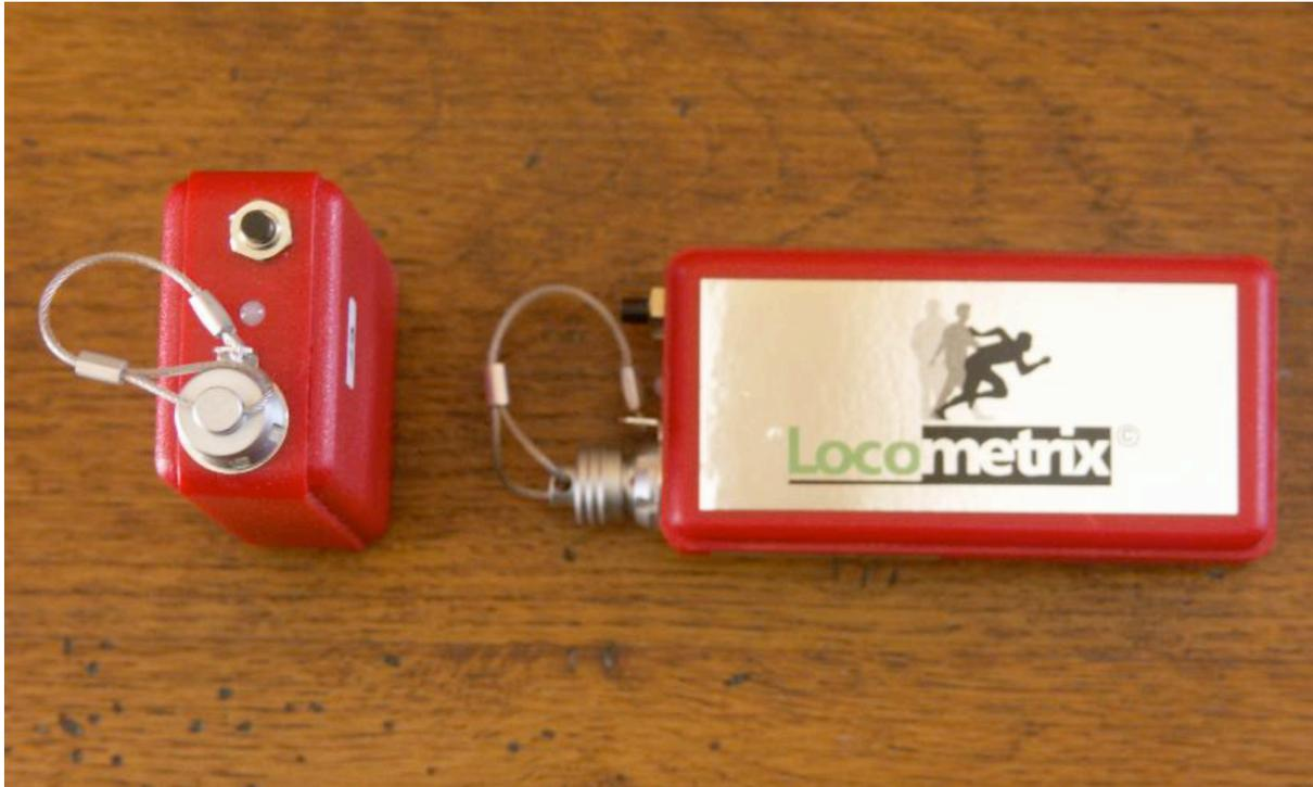
**Figure 2.** Capteur d'accélération (Locometrix<sup>®</sup>, Centauremetrix, Evry, France)
