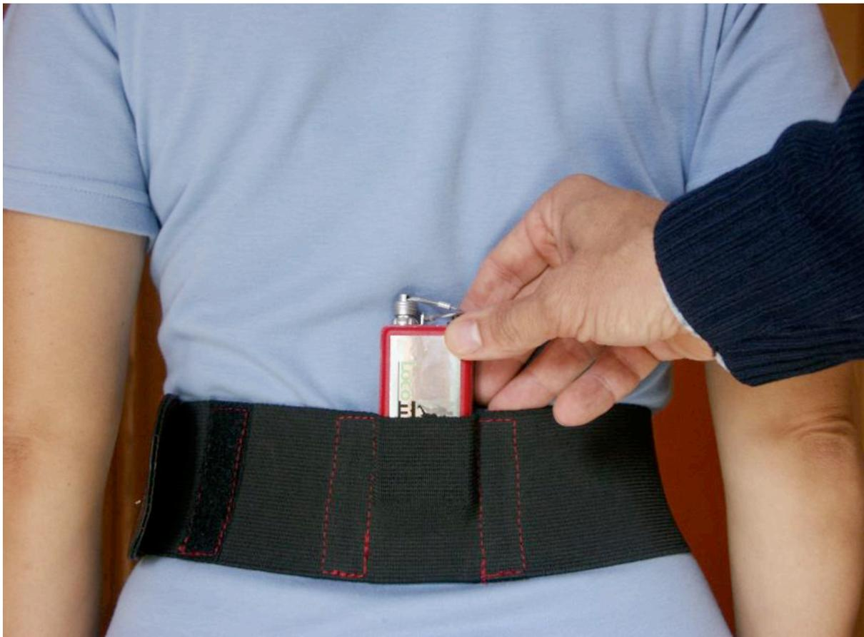
**Figure 3.** Positionnement du capteur d'accélération Locometrix<sup>®</sup>
