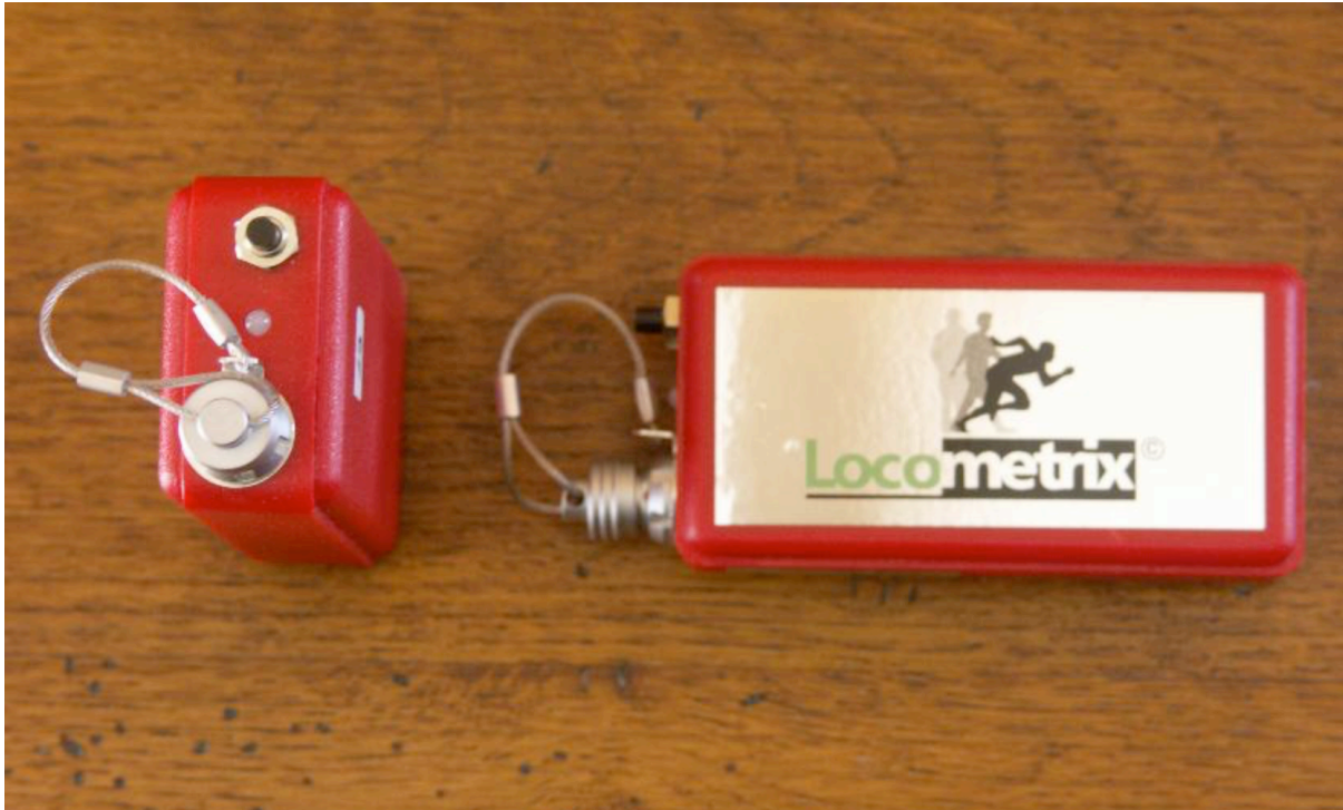
Figure 2. Capteur d'accélération (Locometrix ® , Centauremetrix, Evry, France)
