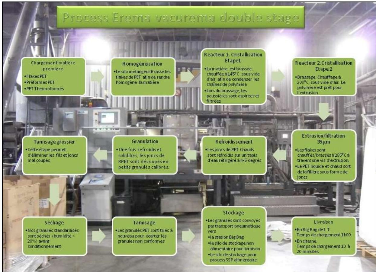
Figure 3 : Schéma de la ligne EREMA VACUREMA
