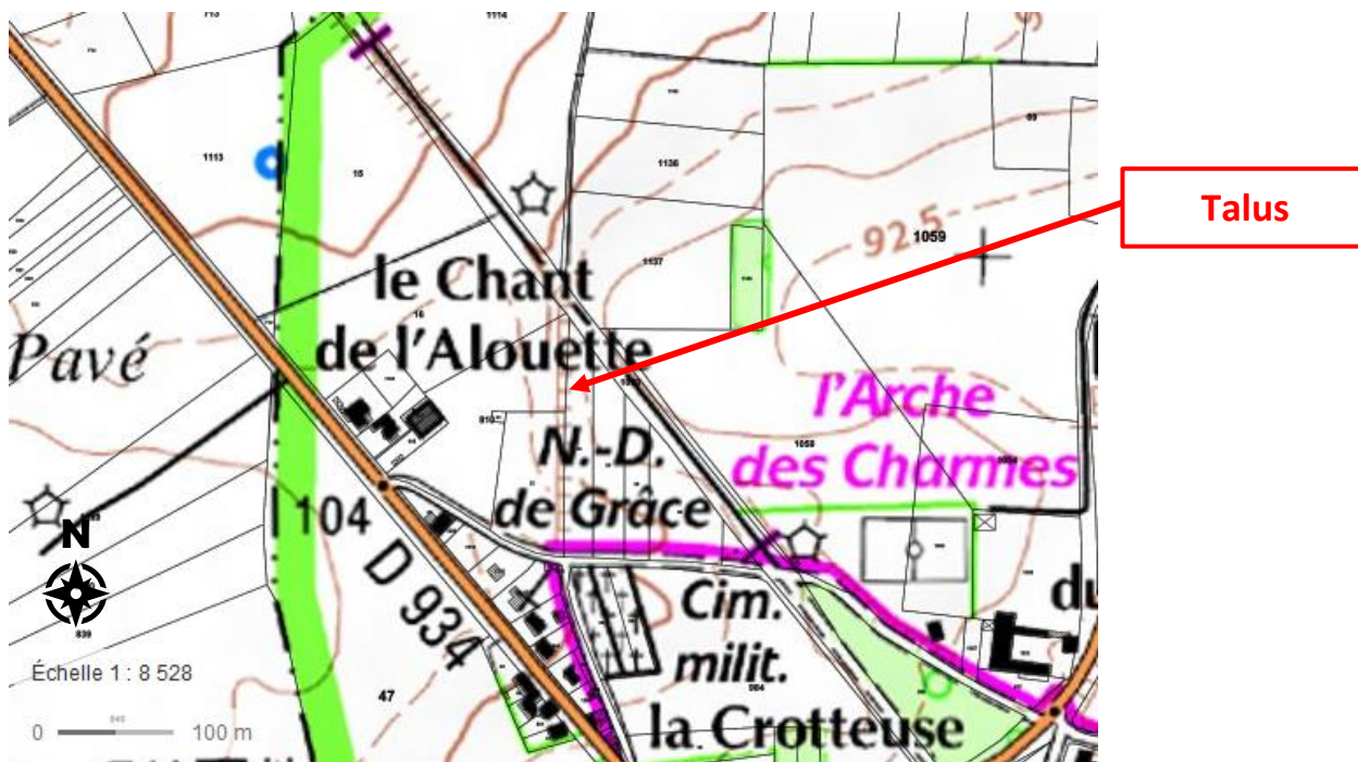
Figure 20 : Exemple de talus indiqué sur une carte topographique IGN, ici sur la commune de Jenlain (59), via le site Géoportail
