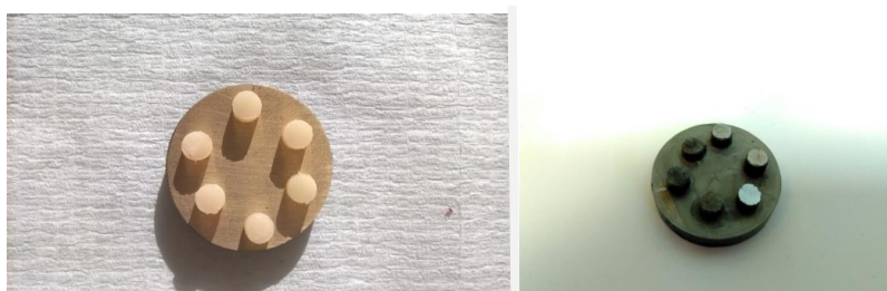
Figure 22. A gauche : avant métallisation ; à droite : après métallisation
